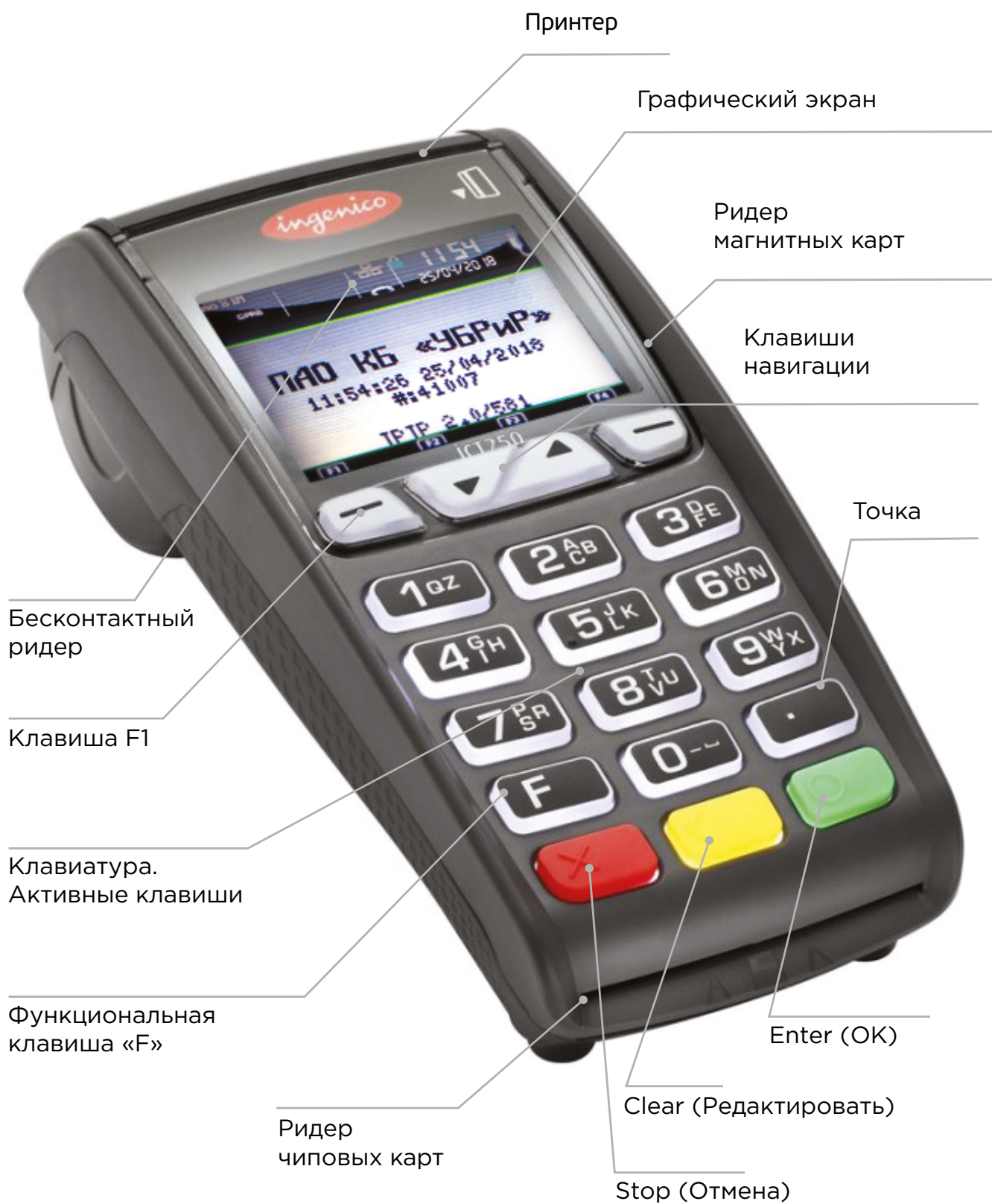
Рис. 1. Назначение клавиш терминала серии ICT / IWL
