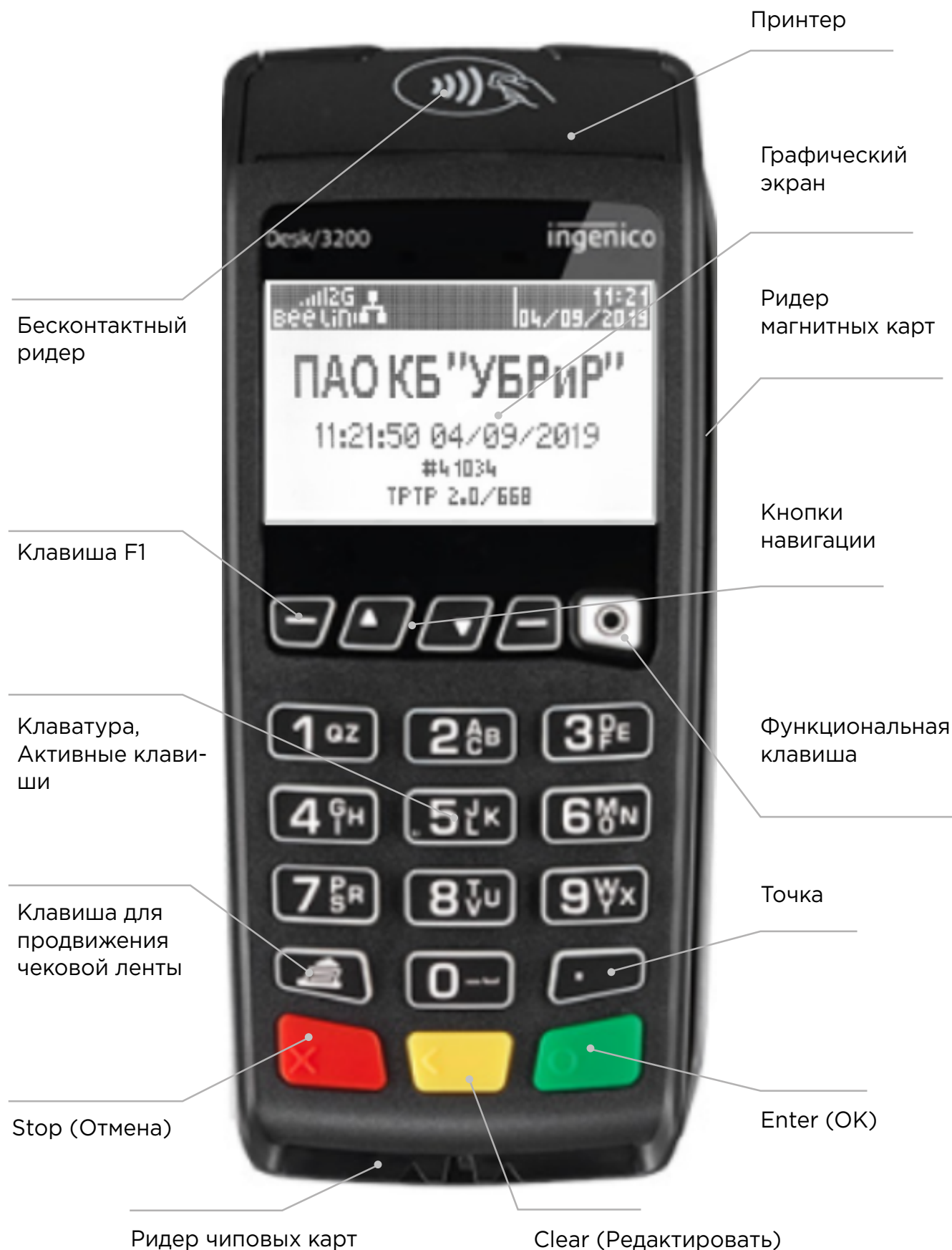
Рис. 4. Назначение клавиш терминала серии Move/Desk
